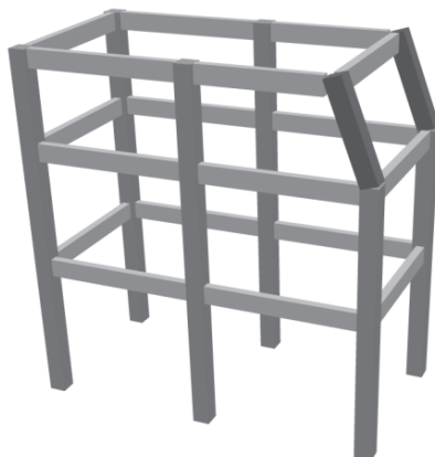
Κεκλιμένα (λοξά) υποστυλώματα (ΚΑ 5 )
