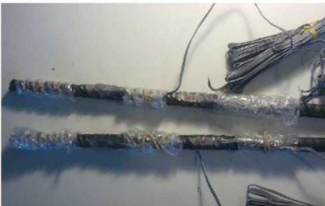
Σχήμα 2. Μείωση Συνάφειας με περιτύλιξη.
